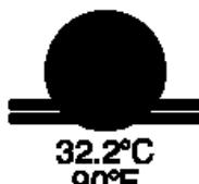
**Низкая температура.** Нажатие этого переключателя активирует режим установки, при котором она всасывает воздух из помещения, нагревает его до температуры  $32,2^{\circ}\text{C} + 4,0^{\circ}\text{C}$  /  $-2,0^{\circ}\text{C}$  и подает к пациенту через одноразовое термоодеяло. Загорится светодиодный индикатор, указывая на то, что установка находится в режиме низкой температуры
