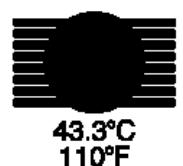
**Высокая температура.** Нажатие этого переключателя активирует режим установки, при котором она всасывает воздух из помещения, нагревает его до температуры  $43,3^{\circ}\text{C} + 4,0^{\circ}\text{C}$  /  $-2,0^{\circ}\text{C}$  и подает к пациенту через одноразовое термоодеяло. Загорится светодиодный индикатор, указывая на то, что установка находится в режиме высокой температуры. **При использовании режима высокой температуры необходимо пристально наблюдать за пациентом.**
